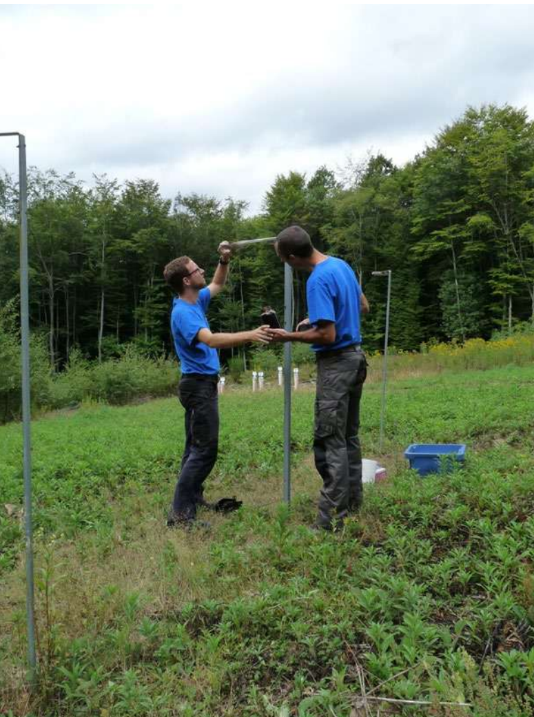
Passivsammlersystem zur Messung von Luftschadstoffen an der Level-II-Fläche Fischbach; Foto: D. Hemmerling
