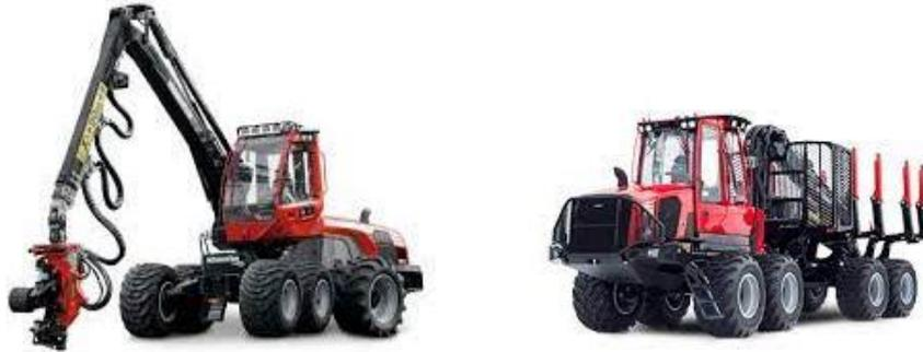
**Bild 2: Harvester- Forwarder- Kombination (HFK) zur Holzernte.**
